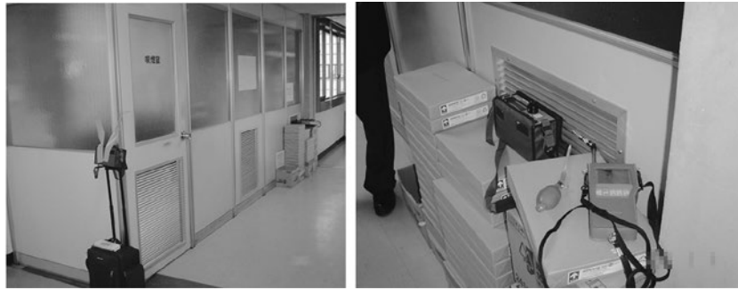
図5 廊下の一角にパネルで作られた喫煙室 (左：喫煙室全景と押し込み式のドア、右：出入口と反対側のガラリーの外側に設置された粉じん計)
